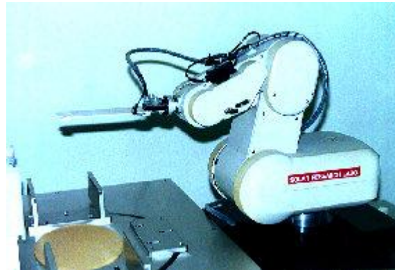
로봇에 의한 비접촉 Wafer 반송장치
